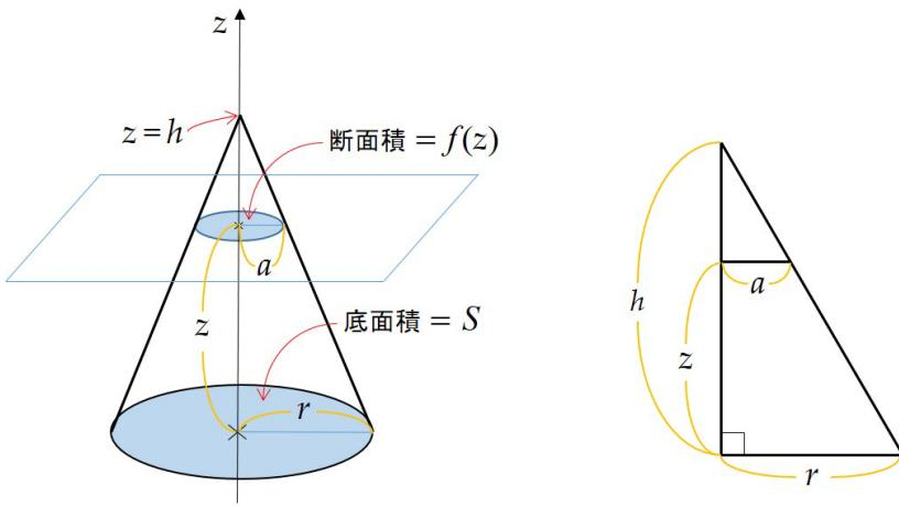
左図のように、円錐を高さ  $z$  の水平な平面で切り、その断面積を  $f(z)$  とする。底面の円の半径を  $r$  とすると、底面積は  $S$  なので  $S = \pi r^2$  である。
