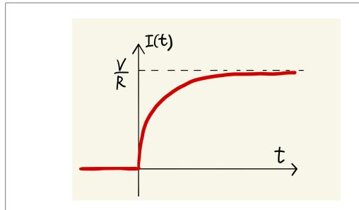
スイッチを入れても電流値は即座に反応せず、応答に遅れが生じている.しかし、十分な時間が経過後には、コイルがないときの電流値に収束している.
